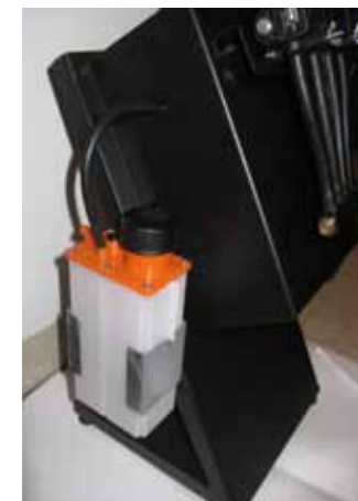
Serbatoio Liquido Lavaggio Iniettori.
